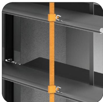
Das Leiterkordel-System HAGO FIX® besteht darin, dass die spezielle Stahlklemme in der Lamelle inklusive Kugel platziert wird, die als integraler Bestandteil der Leiterkordel fungiert. Das Einspannen der Kugel in die Klemme erfolgt über eine Vorrichtung und damit wird nach dem Hochziehen des Lamellenpakets für den richtigen Verlauf der Leiterkordel gesorgt (siehe Abbildung unten).
