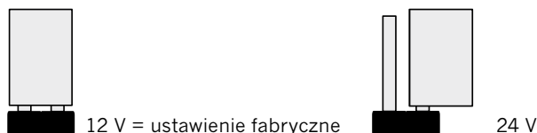
Rys. 3.5.1-3: Montaż zworki do wyboru napięcia
