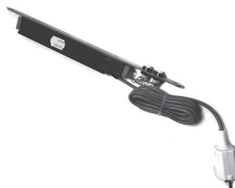
Das Prüfgerät dient zur Überprüfung / Fehleranalyse des A-Öffners, GENIUS A und B sowie GENIUS PANIK ab Version 2.1.
