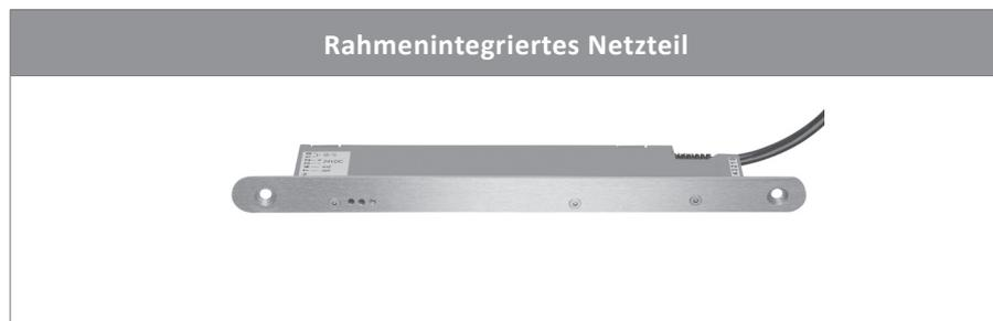
Das Netzteil ist für die Montage im Türrahmen vorgesehen (Fräsung erforderlich), verwendbar für GENIUS oder A-Öffner und KfV Zutrittskontrollsysteme. Stulplänge 320 mm Edelstahl matt gebürstet.
