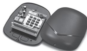
Der externe Transponder dient zum Empfang der Daten von der Transponder Antenne. Spannungsversorgung 12 oder 24 V AC/DC kann vom Genius-Netzteil mit versorgt werden. Bis zu 99 Transponder Schlüssel können einprogrammiert werden.
